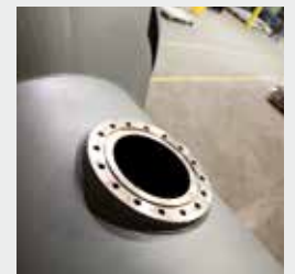
Flansch zur Montage der Spannungszuführung im oberen Behälterbereich
