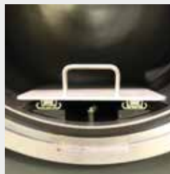
teleskopierbare Prüfstückauflage für die einfache Bestückung mit Prüflingen
